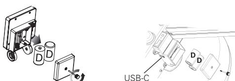
Use 1.5 volt alkaline D Cell (LR20) batteries.
